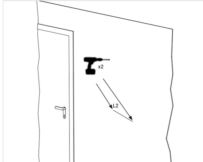
3. Die Halterung werden mit Schrauben und Dübeln, die für die Installationsumgebung geeignet sind, an der Wand befestigt.
