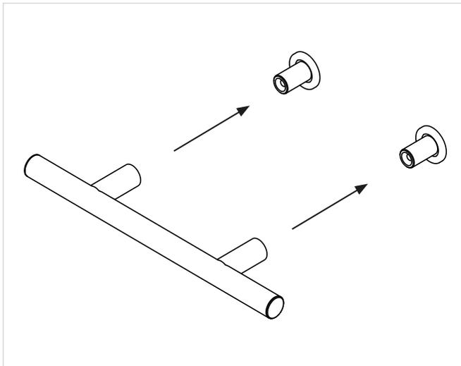
5. Befestigen Sie den Haltegriff mit den vier Schrauben M4X8 an der Halterung.
