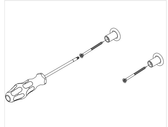
4. Montieren Sie den Haltegriff an der Halterung.
